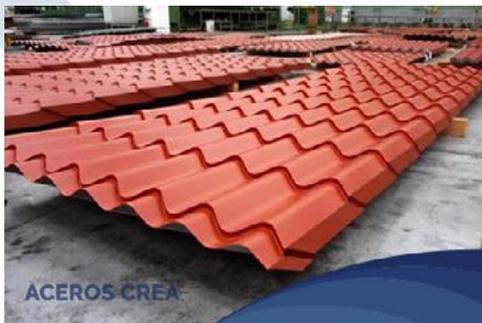
**Lámina de acero acanalada** tipo teja de barro. Es la más apta para acabados de techo residencial por su sistema de teja más ligero. Es un sistema de techado metálico, que se fabrica con base de acero galvanizado calibre 26, el cual atraviesa un proceso de pintado, acanalado y troquelado que le da la apariencia de teja tradicional pero con la resistencia y durabilidad del acero.
