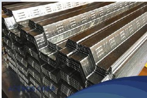
**Losacero** es una cubierta formada por una lámina que se fija a las estructuras a través de pernos o bulbos de acero soldados al patín superior de las vigas aprovechando al conector como elemento de fijación, de manera que cuando llega a ocurrir un movimiento telúrico, la lámina, la losa de concreto y las mismas vigas actúan como una sola pieza, evitando así que los techos se derrumben.
