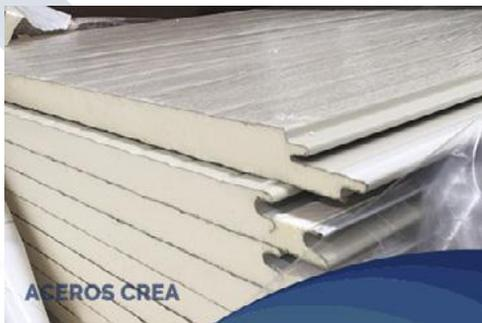
**Panel aislante** fabricado en proceso continuo, compuesto por un núcleo de espuma rígida de poliuretano y dos caras de acero. Ideal para muros de fachadas, tipo sandwich, con fijación oculta, inyectado en línea continua con poliuretano expandido de alta densidad (40 Kg/m<sup>3</sup>), con ambas caras en **lámina de acero galvanizada prepintada**.
